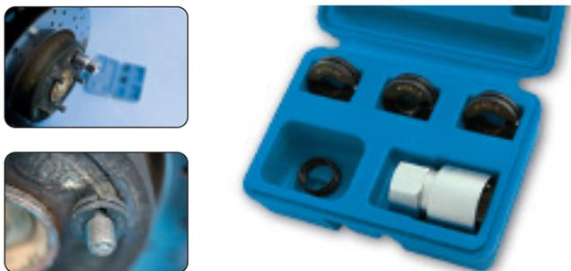
El diseño dividido permite montar las dos mitades del restaurador (normalmente en la base del espárrago) y después enroscar remontando a lo largo del espárrago dañado. El juego incluye tres matrices divididas para adecuarse con los tamaños de rosca del espárrago de rueda mas comunes: M12 x 1,25mm / M12 x 1,5mm / M14 x 1,5mm. Tamaño del adaptador hex: 24mm
