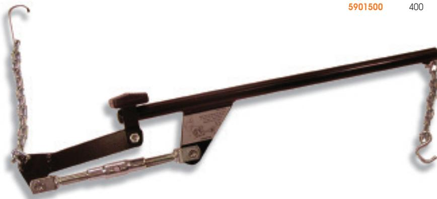
Extractor de brazos de suspensión y de amortiguadores para turismos y vehículos comerciales ligeros. Indicado para desenganchar los amortiguadores de Ford y VW. El útil puede hacer una fuerza de 500 Kg. Se nota que cuando el tubo de la herramienta cierra durante la tensión, se crea una fuerza sobre el brazo oscilante de más de 300 Kg. Por tanto, es mejor interrumpir la rotación del útil y trabajar sobre ambas cabezas cilíndricas o cónicas del brazo oscilante.
