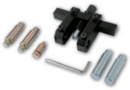
Herramienta para extraer las rótulas de dirección, permitiendo la sustitución y re-acondicionamiento de los amortiguadores, sin riesgo de dañar a las rótulas con y sin ranura centralizada al ser ajustable.
